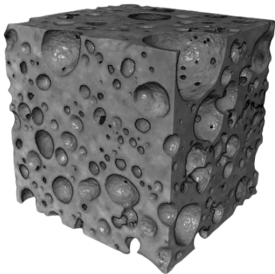
利用显微原位CT观察玄武岩（左）及玄武岩内部孔隙球棒模型（右）
