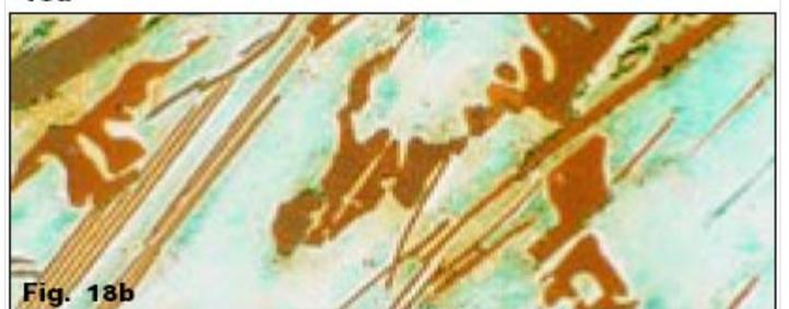
图 17. (上) 含有块状碳化物（白色）和珠光体的白口铸铁显微组织，侵蚀剂：4% 硝酸酒精溶液，100x。图 18. (中和下) 高放大倍数(400x)下白口
