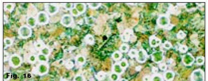
图 14. (上) 铁素体基体的球墨铸铁，侵蚀剂：4% 硝酸酒精溶液，100x。
