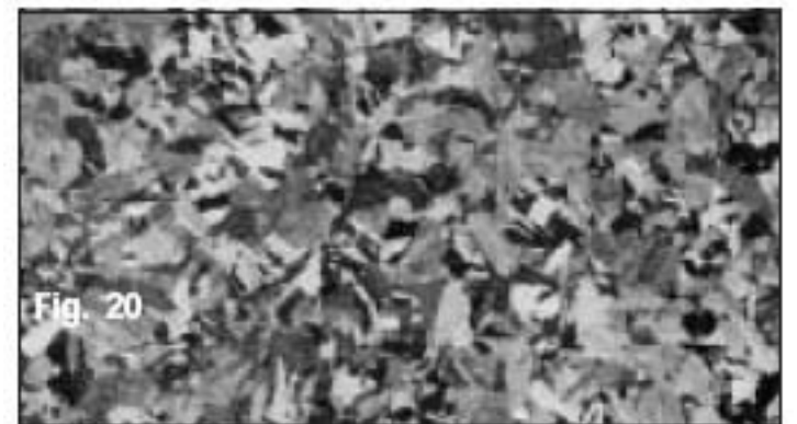
图 19. 52100轴承钢样品奥氏体化后, 细晶粒中的板条马氏体(白色, 球状的颗粒是未溶解的碳化物) 1000x (2% 硝酸酒精溶液)。与图5所示的粗片状马氏体相比, 该组织已经没有马氏体特征。
