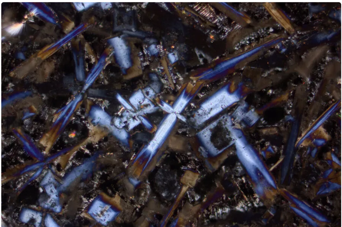
含有黄长石晶体的高炉炉渣，根据其干涉颜色显示出明显的分带。干涉色从棕色（边缘）到蓝色（核心）的变化表明晶体生长过程中化学成分的变化（降低镁含量）。DM4P显微镜使用透射光、20x N平面DS（色散染色）物镜和偏光镜的成像
