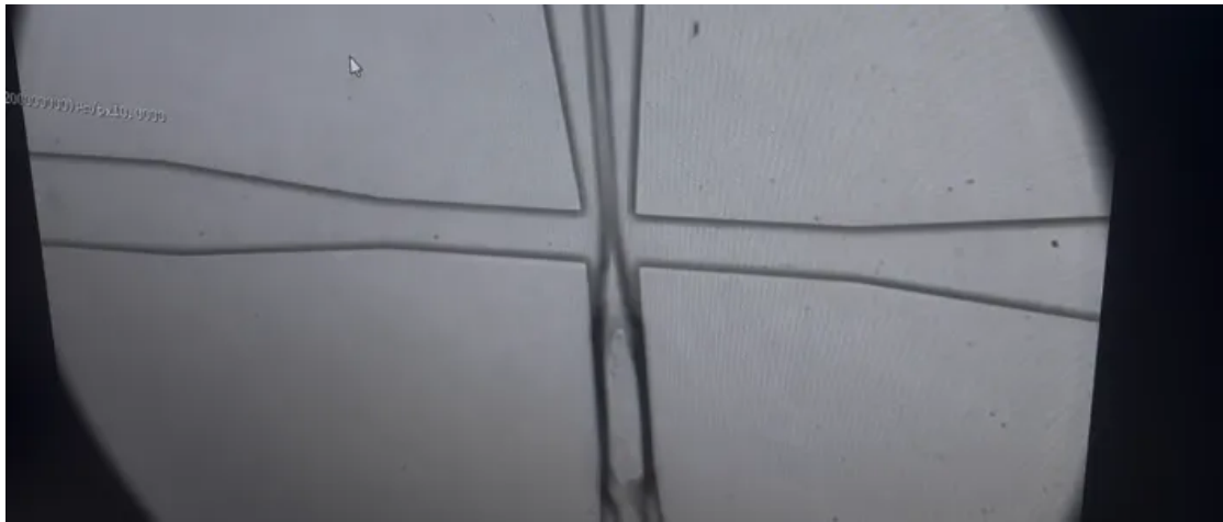
如图2.1所示，孔道中液滴在常规显微镜观测中呈现连续模糊线条
