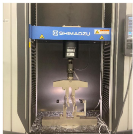
手机屏玻璃的弯曲试验
