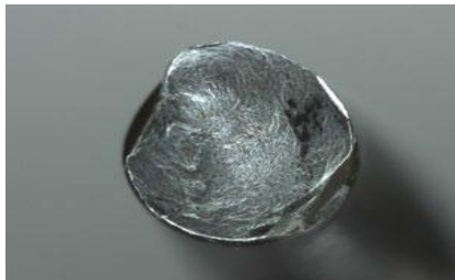
轮胎上螺栓的裂痕观察
