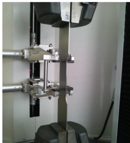
汽车薄板拉伸试验
