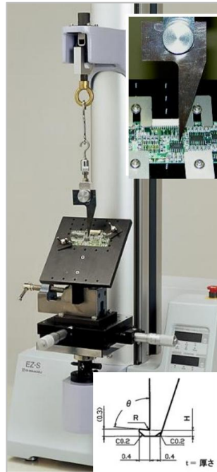
电路板封装部件结合强度测试
