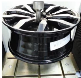
轮毂侧向力试验
