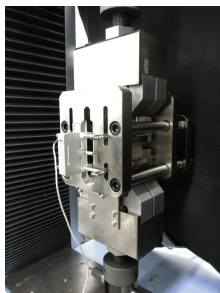
金属钢板的面内反转负荷试验（包辛格效应评价）
