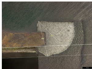
焊接熔深熔宽测量
