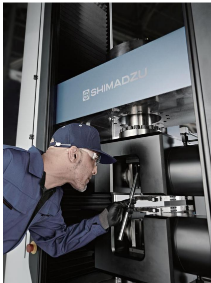
金属棒材拉伸试验
