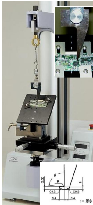
印刷基板封装部件结合强度测试
