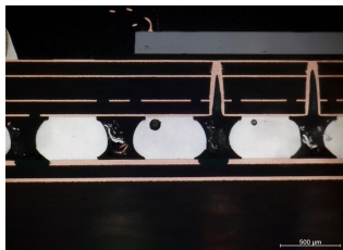
PCB切片BGA空洞裂纹观察
