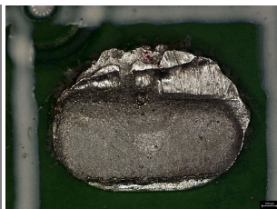
PCB锡球、焊点断口三维形貌观察及轮廓测量
