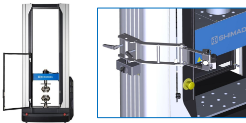
材料试验机+视频引伸计
