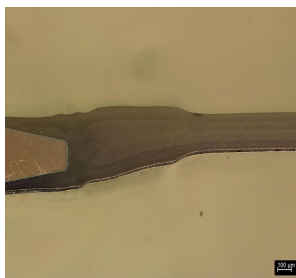
极耳截面多层结构测量
