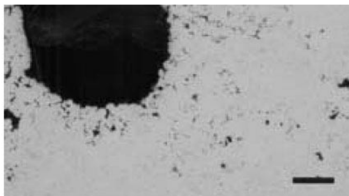
图 5a 和 b. AM60 (上图) 和 AZ91D (下图) 合金抛光表面, 最终抛光步骤使用 MasterPrep™ 氧化铝抛光液 (标尺长度分别为: 20 μm 和 100 μm。)
