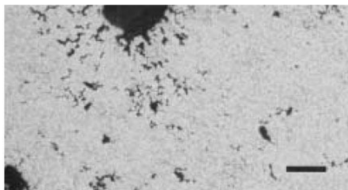
图 6a 和 b. AM60 (上图) 和 AZ91D (下图) 合金的抛光表面, 最终抛光步骤使用 MasterPolish® 氧化铝和二氧化硅的混合抛光液。(标尺长度 100 μm)。
