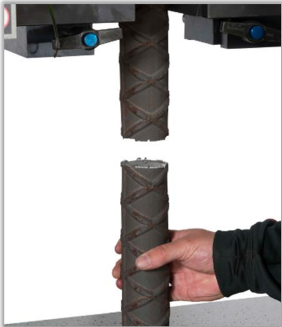
图5—断裂后的 #18 (57 mm) 钢筋分离（弹回）
