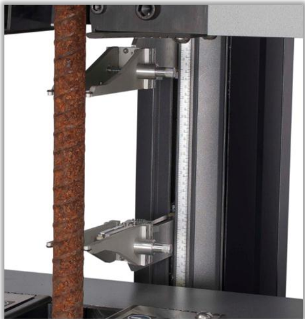
图7—1500KPX 上的 AutoX750 11 号 (36 mm) 钢筋试验
