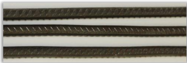
图 2 — 非盘曲的钢筋在长度方向上展现出轻微的弯曲
