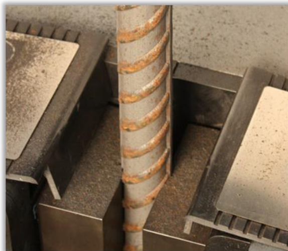
图 4 — 一次试验后下夹具堆积大量鳞垢
