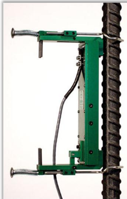
图6—手动夹持式钢筋引伸计
